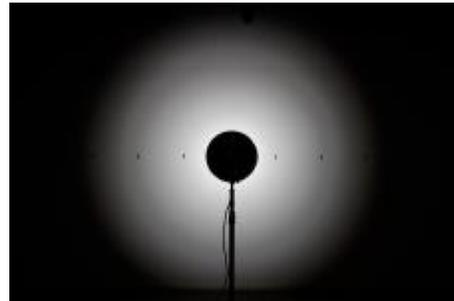
Augmente le rendement lumineux de 2,4 f-stop, produit un faisceau de lumière plus concentré, crée des ombres doubles distinctes et est conçu pour être utilisé avec des têtes saillantes.
