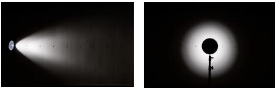
Augmente le rendement lumineux de 2,6 f-stop, produit un faisceau de lumière plus concentré, crée des ombres doubles distinctes et est spécialement conçu pour être utilisé avec des têtes saillantes.
